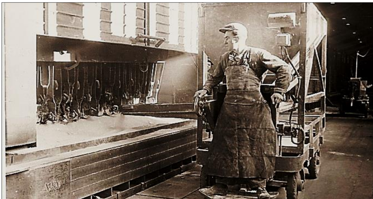
Bosits András timföldet adagolt az oldaltüskés kádnál. Háttérben a kádbetörő gép (Fotó: a családtól) (Forrás: Ajkai Szó)
