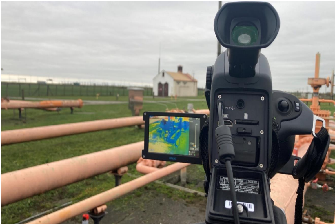
Metánszivárgás detektálás és emissziómérés a felszíni technológián speciális infrakamera segítségével. (Fotó: FGSZ Földgázz szállító Zrt.)
