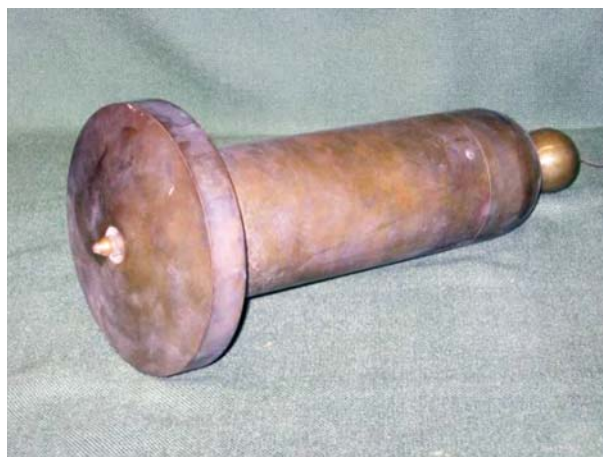
7. ábra. A Veith-féle függőlemezű Szentistványi Gyula által továbbfejlesztett változata
