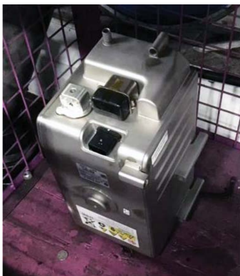
10. ábra. Hibrid személyautó kis teljesítményű Li-ion akkumulátora (j), elektromos jármű Li-ion akkumulátor cellája (Fotó: Pataki Gábor) (b)
