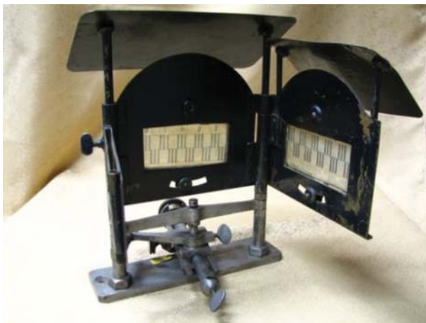
3. ábra. Cséti-féle lengésmegfigyelő készülék
