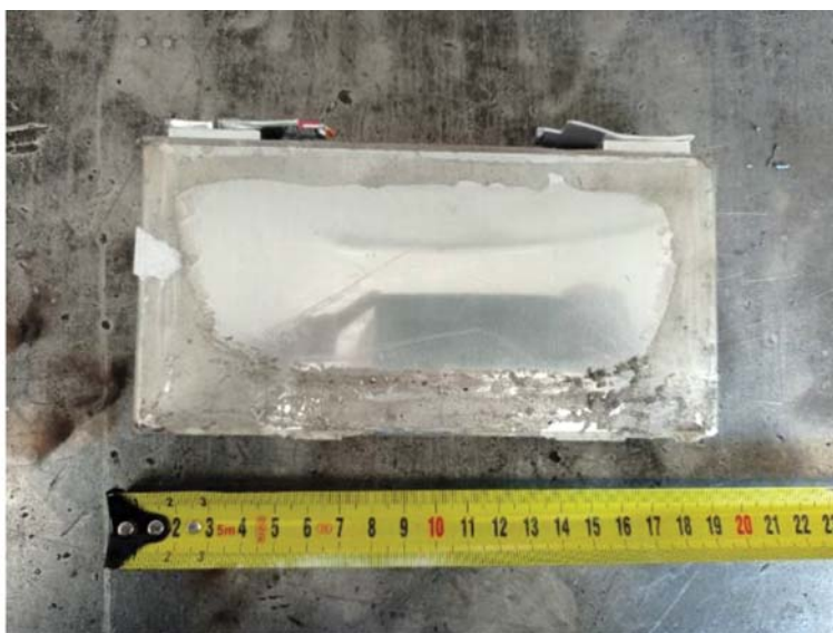
10. ábra. Hibrid személyautó kis teljesítményű Li-ion akkumulátora (j), elektromos jármű Li-ion akkumulátor cellája (Fotó: Pataki Gábor) (b)
