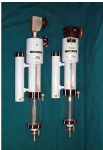
21. ábra. A miskolci hidrosztatikai szintező
