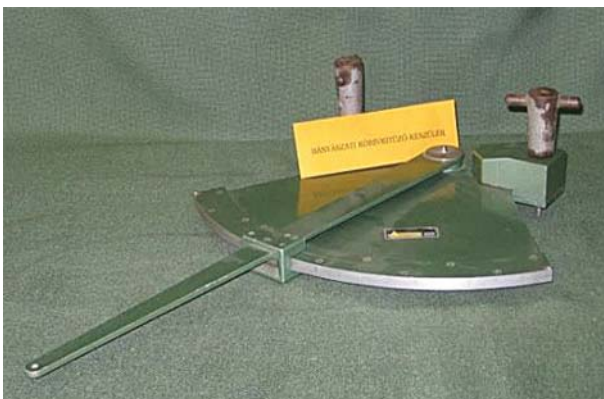
17. ábra. Fénykép a bányászati körívkitűző készülékről
