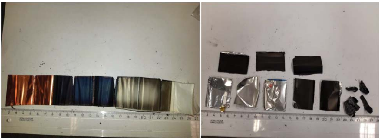
8. ábra. Szétbontott mobiltelefon-akkumulátor: anód- és katódtekercek (b), ház és black mass bevonat (j) [7]
