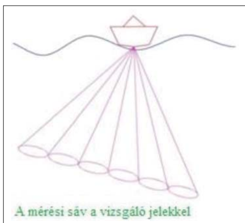
4. ábra. Multisugaras szonár mérési sávja
